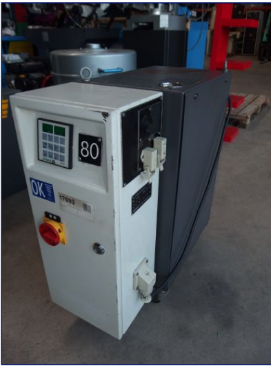
Atemperador molde agua 9 kw. Presurizado REGLOPLAS AG P140/9/SG51/1K/RT45 Ref: 17693
